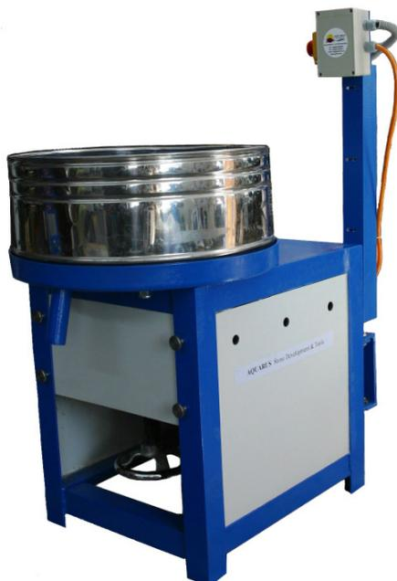
Kugelschleifmaschine mit konstanter Geschwindigkeit. Für die Herstellung in Größenmengen für Kugeln mit einem Durchmesser von 4 mm bis 25 mm. Die Maschine ist mit einer Rillenplatte und Lochmatrix zum Schleifen von Kugeln ausgestattet.
